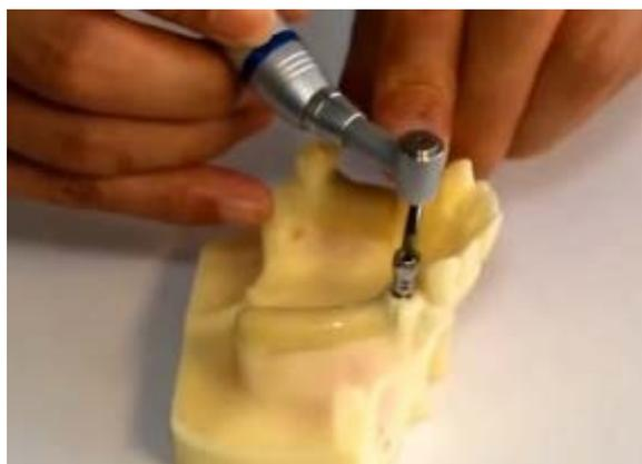
5. Высверлите пилотной фрезой через втулку в направлении против часовой стрелки отверстие в торце отломка винта на глубину 1-2 мм (втулка ограничивает максимальную глубину погружения фрезы до 4мм). Рекомендуемая скорость вращения пилотной фрезы 1200-1400 об/мин.
